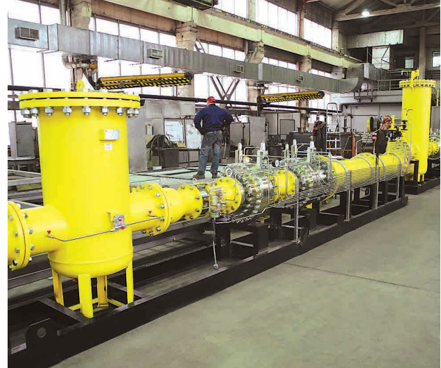
Технические решения на базе регуляторов давления МЕТРАН, собранные в технологическую линию редуцирования на опорной раме
